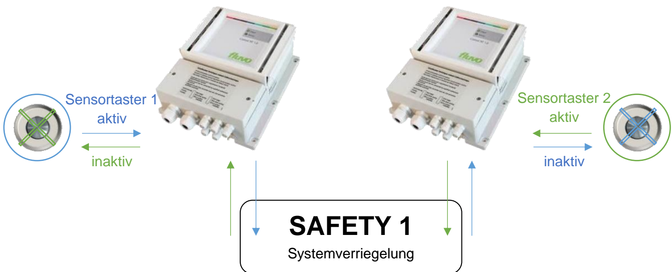
Abb. 1: Funktionsschema für den sicheren Einsatz von zwei Attraktionen.
