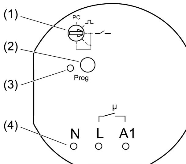
Bild 1: Funk-Schalt-/Tastaktor
