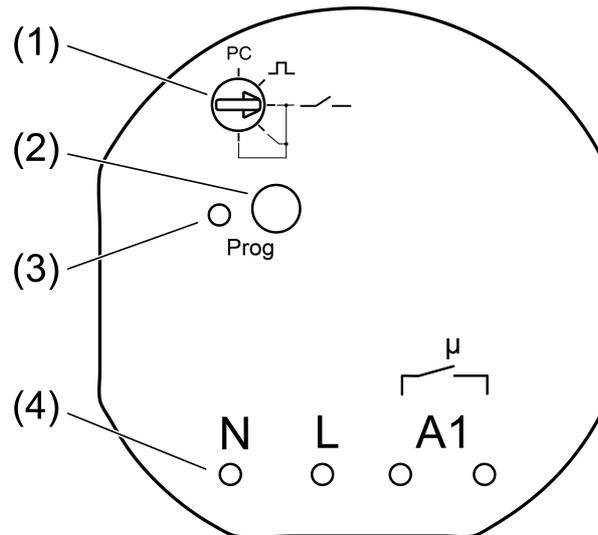
Bild 2: Funk-Schalt-/Tastaktor potentialfrei
